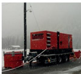
**Resistencia a intemperie.** Preparados para hacer frente a la entrada de agua, la corrosión por humedad y elevada salinidad, la acumulación de hielo y nieve y la pérdida de potencia por sobre-temperatura. HIMOINSA ofrece grupos electrógenos capaces de resistir más de 1000hr a la prueba de niebla salina (salt-spray test). Estos resultados se han obtenido sin sacrificar la prestación acústica ni la capacidad de ventilación y refrigeración del motor la cual está garantizada hasta 50°C.
